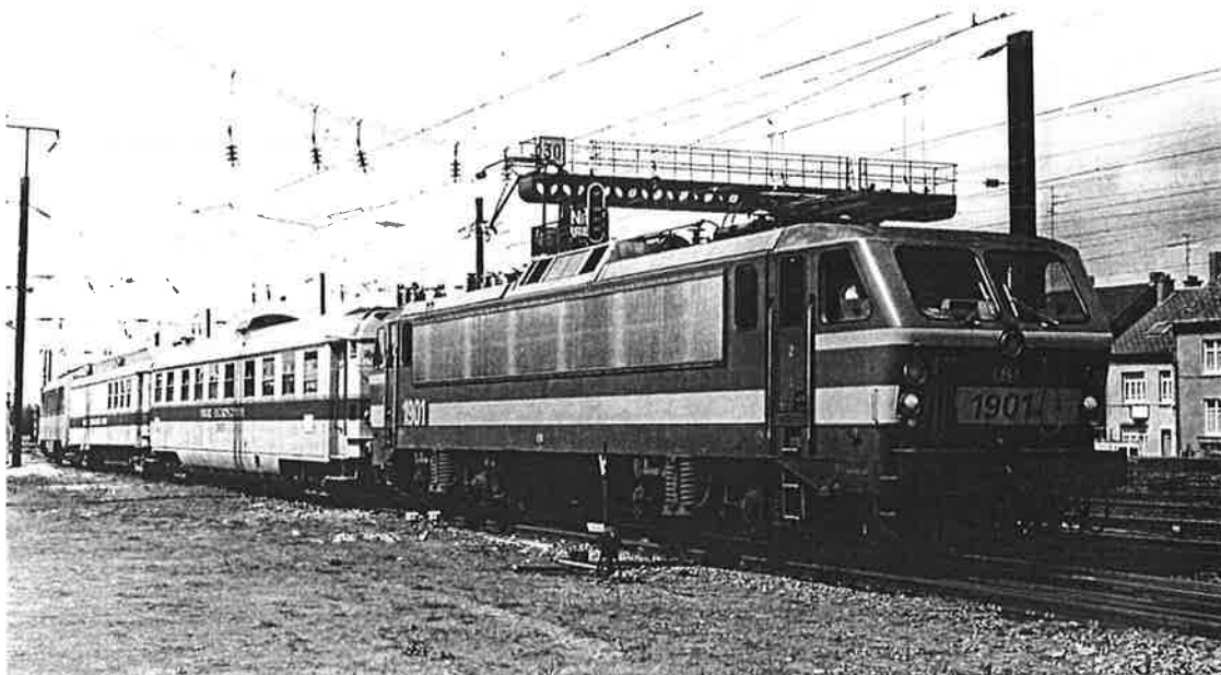
En vue de son homologation par la SNCF la 1901 a effectué une quinzaine d'essais sur le tronçon Hirson – Aulnoye. La rame comporte deux voitures de mesure et, en queue, une Sybic pour assurer la réversibilité. Aulnoye, le 22 mai 1996 – Photo Guy Bridoux
